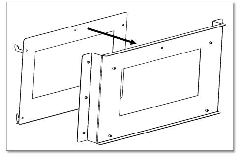
TO MIDDLE PLATE INSTALL ORIGINAL BACK PLATE FROM AGERA 22 FASTENING BY 4PCS OF SCREWS M5
