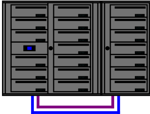
Illustration av ett boxsystem bestående av en dubbel grundmodul och en singel tilläggsmodul
